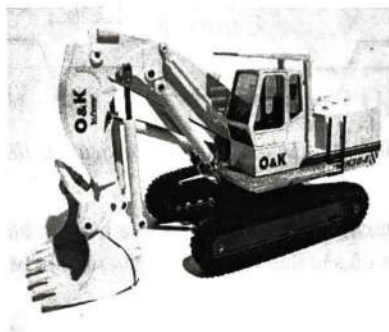
Hình 3-3: Máy đào gầu thuận.
